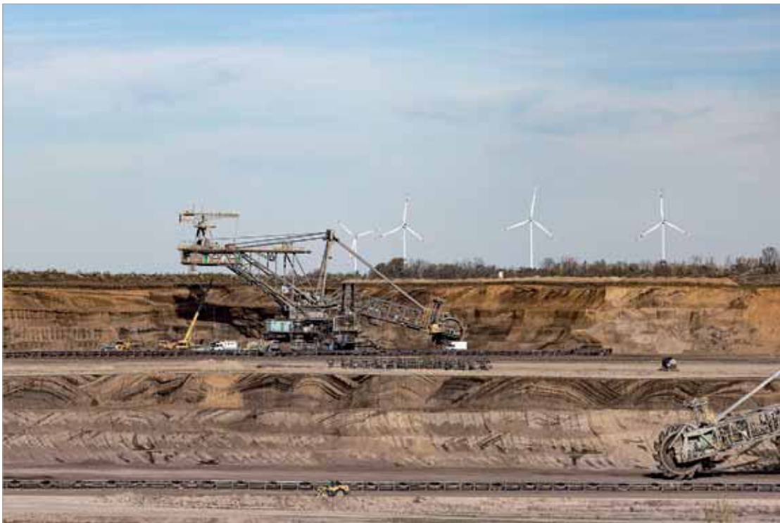
Tagebau Profen / Baufeld Domsen – Schaukelradbagger 1511 (Typ SRs 2000) im 1. Abraumschnitt. Foto: Matthias Behne, laut wie leise.
